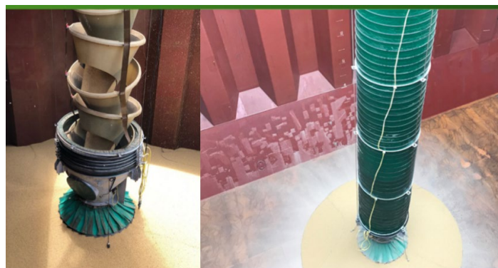
Фиг. 5 Каскадна система от конуси, окачена на корабен товарач, за товарене на зърно
