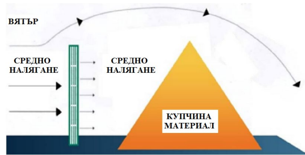
Фиг. 3 Въздействие на вятъра върху купчина материал при ветрозащитна преграда
