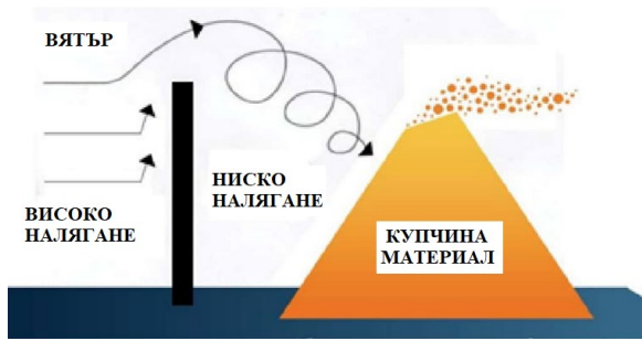
Фиг. 2 Въздействие на вятъра върху купчина материал при непроницаема стена
